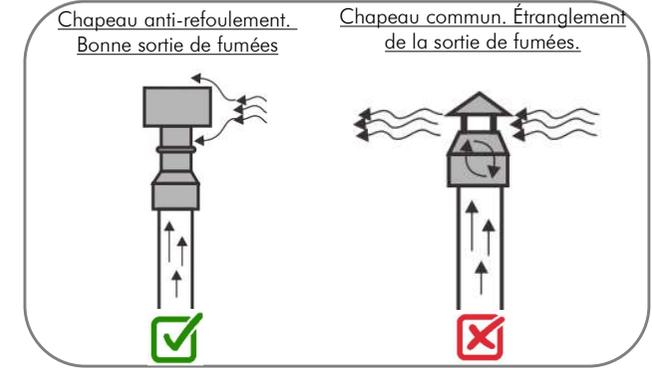
4°.- Installation dans une cheminée en maçonnerie, sortie des fumées jusqu'à l'extérieur.
